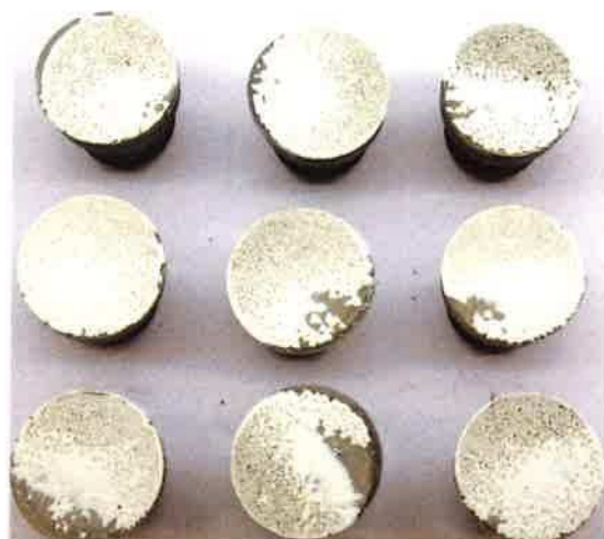
Zdjęcie 3b: Stemple z próby odrywania - Badanie kondensacji
