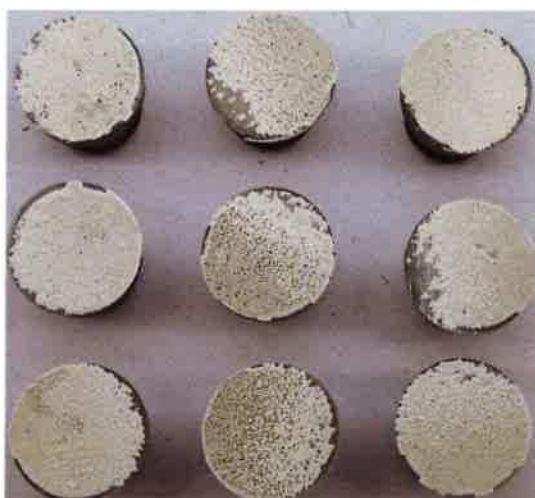
Zdjęcie 1b: Stemple z próby odrywania - Przyczepność początkowa
