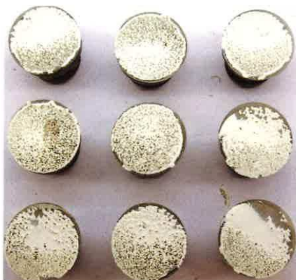
Zdjęcie 2b: Stemple z próby odrywania - badanie w neutralnej mgie solnej
